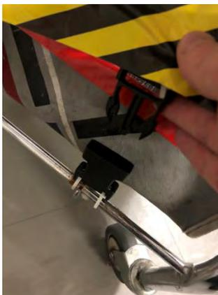
カートの1面が開閉できるように裁断し、下部フレームにバックルを3点装着させた。
