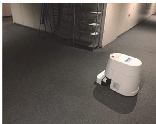
また、現在の人で行う共用廊下除塵作業は、90分で800㎡(528㎡/時)の床面清掃をしているが、内、ロボットが320㎡を受け持つことで、作業者は90分で480㎡(316.8㎡/時)の作業となる。人の手で、ロボットが清掃を行わない範囲(廊下の端・E Vホール)に集中して作業が可能。
