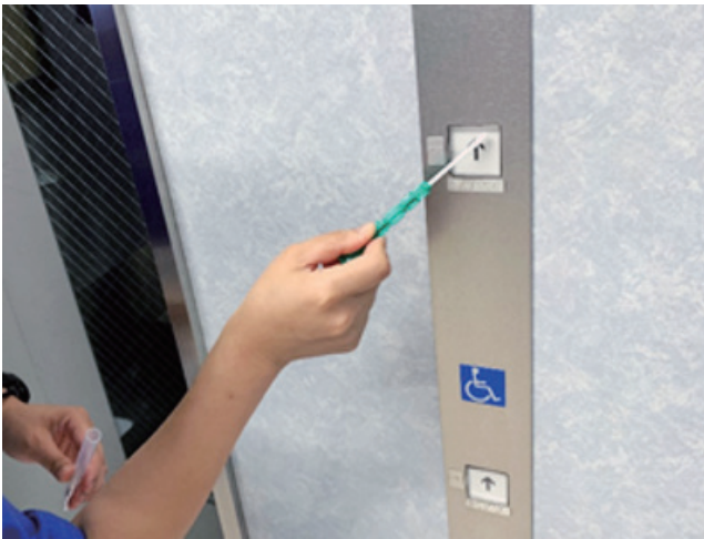
写真7 エレベーター入口ボタンのATP採取
