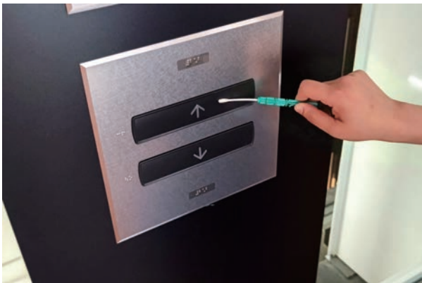
写真6 エレベータ昇降ボタンのATP測定風景
