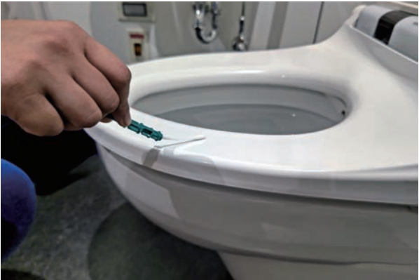
写真4 便座のATP測定風景
