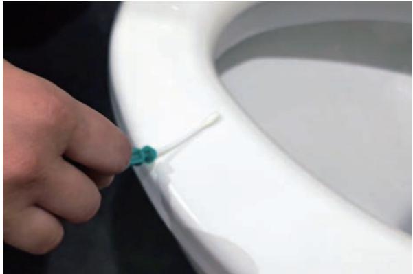
写真5 便座のATP測定風景
