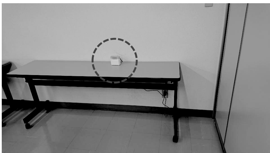
図3-2-4 測定機器設置状況・3F居室内 ※人の出入りによる影響を避けるため、出入口付近を避け設置しています。
