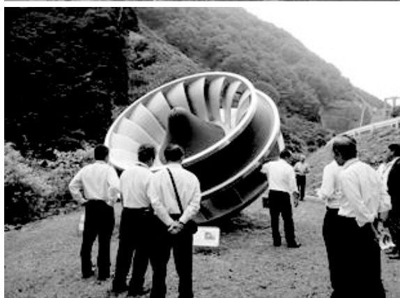
発電機ポンプ水車
