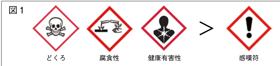
図1 ピクトグラムは「どくろ」「腐食性」「健康有害性」、「感嘆符」の順で優先的に表示する
