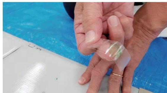
写真8 床面へのセロハンテープ剥がし
