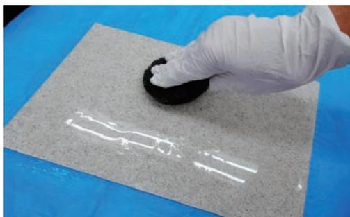
写真10 黒パッドによる剥離作業
